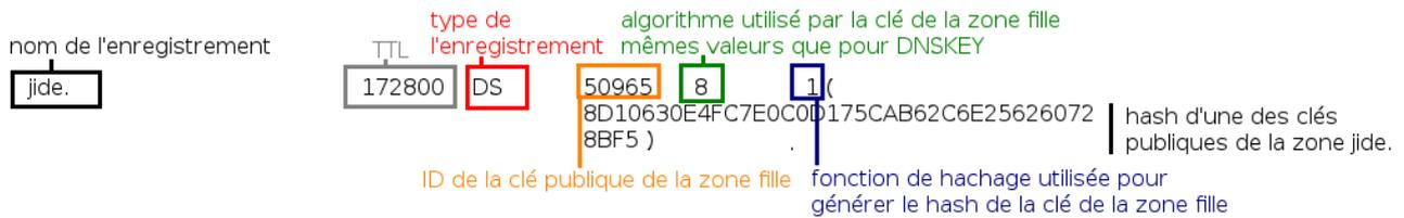
FIGURE 16 – Structure d'un enregistrement DS.
